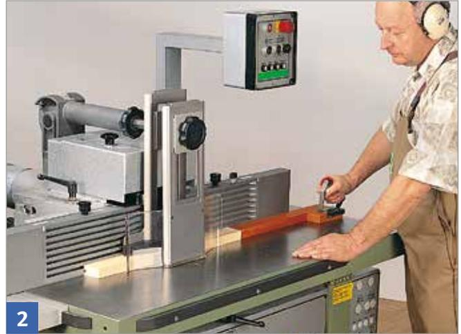
Werkzeugverdeckung vor dem Anschlag anbringen und auf Maschinentisch einstellen; durch die Einstellung soll ein Druck auf das Werkstück zum Anschlag hin erfolgen.
