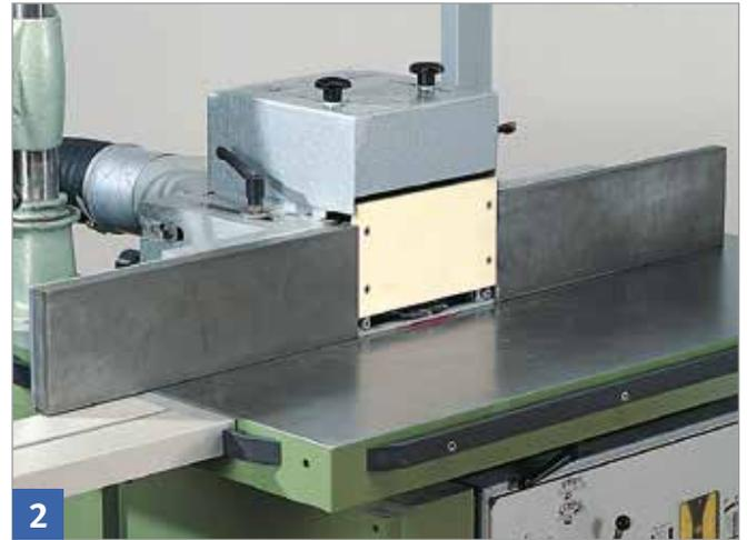
2 In die Anschlaghälften einsetzbare Anschlagbrücken
