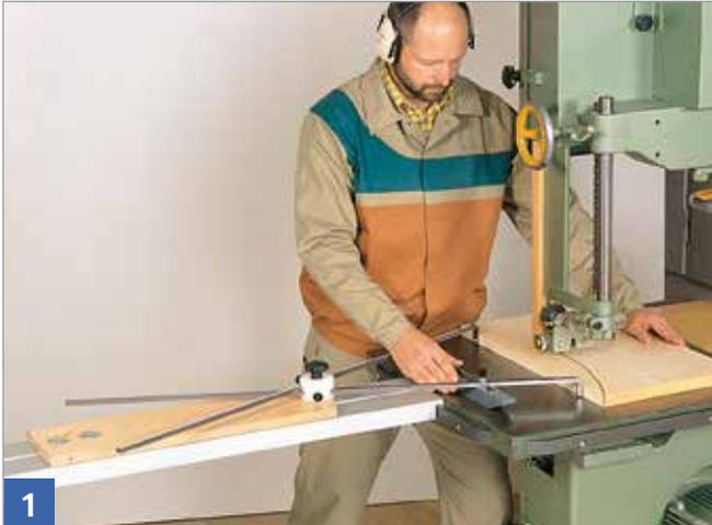
Segmentsägevorrichtung so anbringen, dass eine zur Bandsägeblattebene senkrechte, zwischen Zahnschnecke und Zahngrund verlaufende Linie durch den Drehpunkt der Segmentsägevorrichtung geht.
