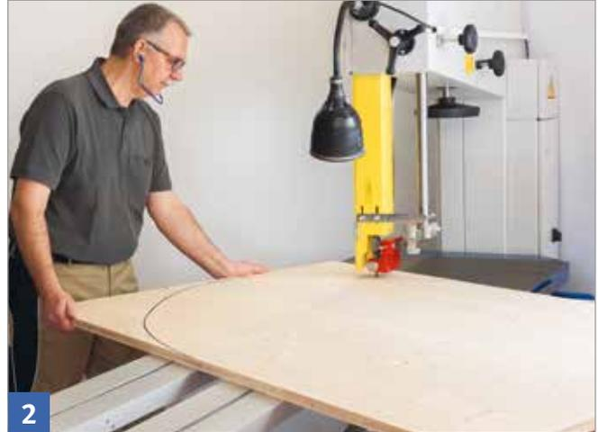
Bei langen oder sperrigen Werkstücken für eine gute Werkstückauflage sorgen, zum Beispiel durch eine Tischverbreiterung.
