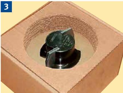
3 Werkzeuge mit Hartmetallwechschelschneiden immer in der Originalverpackung transportieren.
