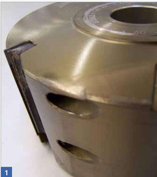
Durch Werkzeugsturz deformierter Aluminiumtragkörper
