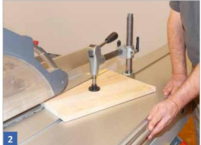
2 Spannen eines Werkstücks ohne Anschlag
