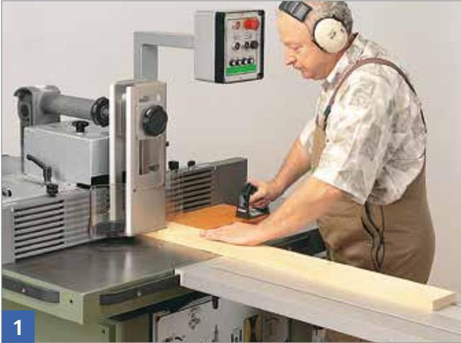
Zur sicheren Werkstückführung durchgehenden Anschlag verwenden.
