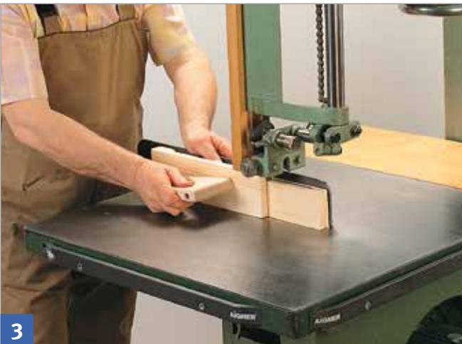
Bei kurzen Werkstücken eine Zuführhilfe (z. B. Schiebelade) verwenden.
