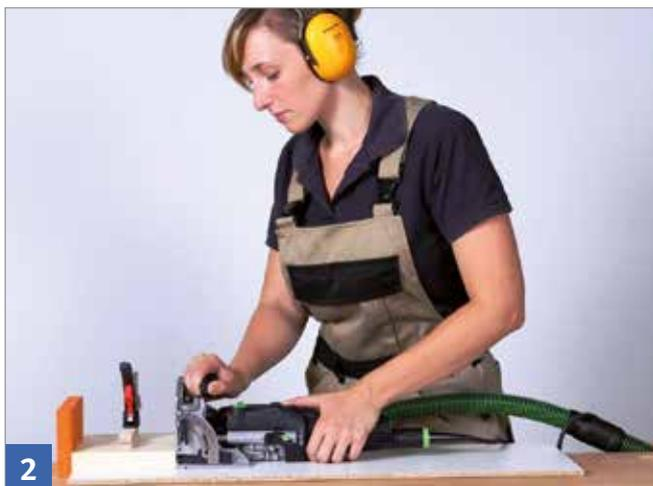
Werkstück bei liegender Bearbeitung auf eine ebene Unterlage auflegen.
