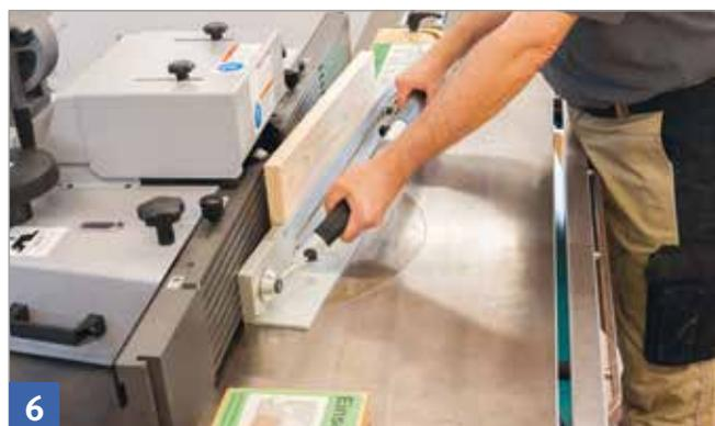
Um die beim Fräsvorgang auftretende Kräfte optimal kontrollieren zu können, ist die gezeigte Handhaltung unbedingt zu beachten.
