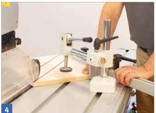
3 Spannen eines Werkstücks zum Winkelsägen
