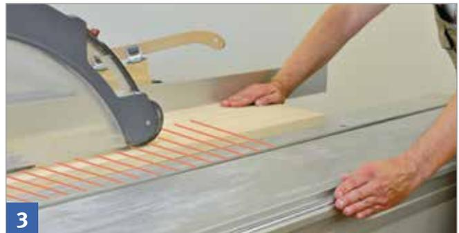
anschließend linke Hand an den Maschinentisch anlegen.
