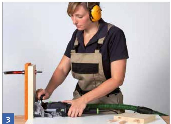
Werkstück bei stehender Bearbeitung durch Stützwinkel sichern.
