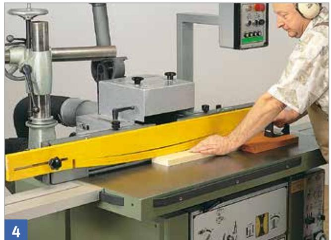
Bei kurzen Werkstücken linke Hand mit geschlossenen Fingern flach auf das Werkstück legen; nicht über die vordere Werkstückkante greifen.
