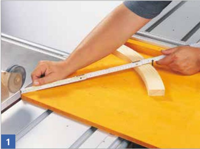
1 Grundplatte am Schiebetisch oder Queranschlag befestigen.
