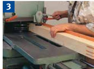
3 Handvorschub = Arbeiten mit dem Schiebeschlitten
