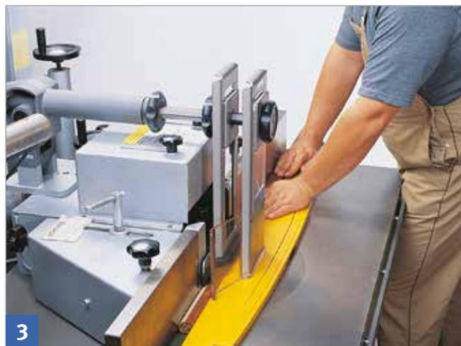
Für kurze Werkstücke eignet sich eine Einlegschaablone. Um den notwendigen Adruck zu gewährleisten, müssen Schablonenhöhe und -tiefe etwas geringer sein als die entsprechenden Abmessungen des Werkstücks.
