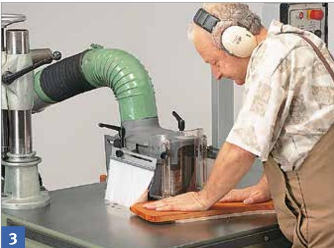
Beim Führen der Schablone von Hand (ohne Vorschubapparat) und für kleine Werkstücke Doppelschablone verwenden.
