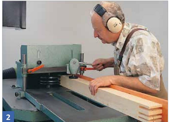
Schiebeschlitten zur sicheren Werkstückführung verwenden. Werkstück mit Exzenterspanner oder pneumatischem Spannzyylinder halten.
