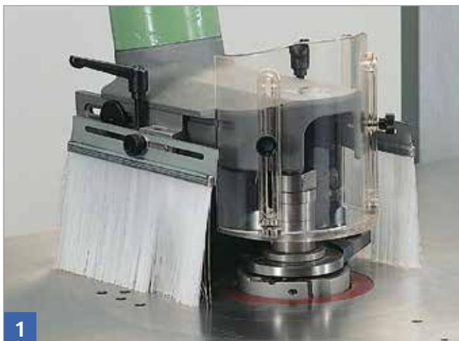
1 Anlaufring oder Bogenfräsanschlag und Zuführleiste zur sicheren Werkstückführung, wenn möglich über dem Fräswerkzeug, anbringen.
