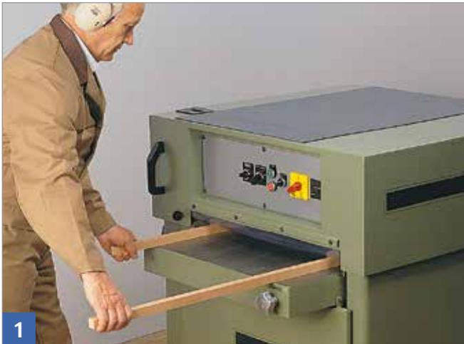
Falls die Werkstücke unterschiedlich dick sind, dürfen bei starren Einzugswalzen und Druckbalken nur zwei Werkstücke gleichzeitig bearbeitet werden. Dabei sind die Werkstücke an den Außenseiten der Einschuböffnung zuzuführen.
