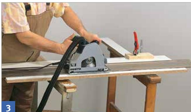
Kreissägeblatt für Plattenmaterial wählen (z. B. vielzahniges HW-Wechselzahn-Sägeblatt).
