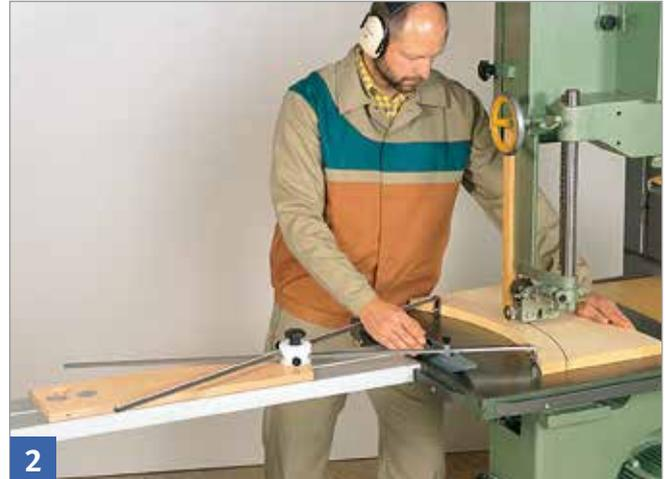
Für das Sägen weiterer Werkstücke aus demselben Ausgangsmaterial berücksichtigen, dass der Außenradius nachgesägt werden muss.
