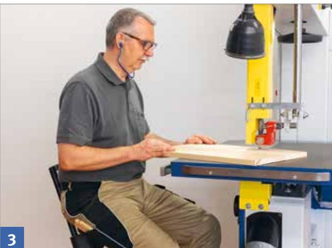
Zum Entlasten der Wirbelsäule eine Stehhilfe verwenden.
