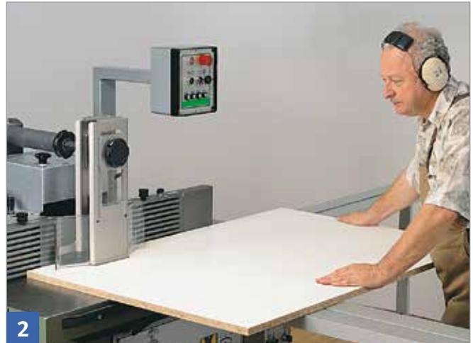
Äußere Werkzeugverdeckung vor dem Anschlag anbringen und auf Werkstückdicke einstellen, inneren Druckschuh so einstellen, dass ein Druck auf das Werkstück erfolgt; möglichst durchgehenden Anschlag oder Anschlagbrücken verwenden.
