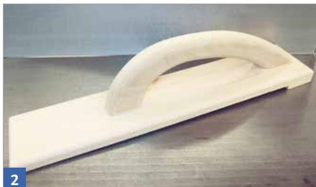
2 oder eine Zuführlade (Bild 2) verwenden.
