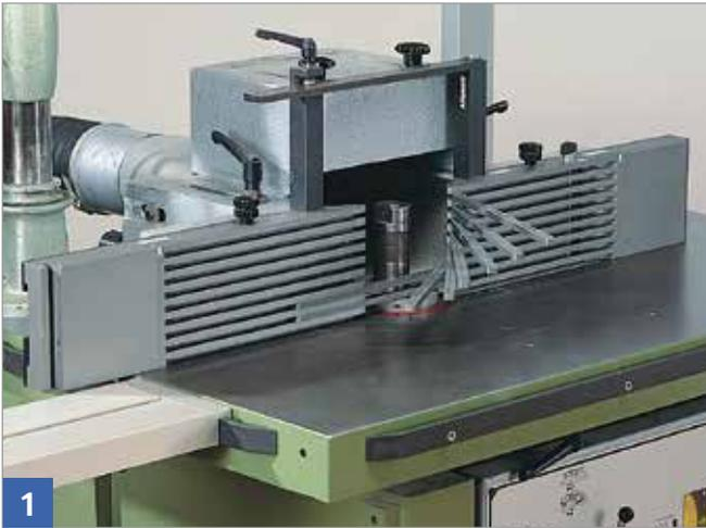
1 Anschlag mit schwenkbaren Überbrückungsstegen
