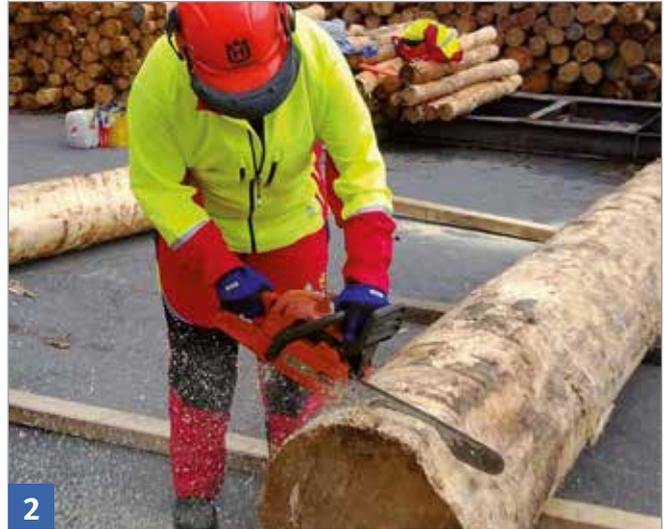
Vor dem Einschneiden sicherstellen, dass Holz nicht in Spannung ist; gegebenenfalls Rundholz zurechtrücken oder unterkeilen, um eine plötzliche Lageveränderung des Rundholzes oder Einklemmen der Säge zu vermeiden.
