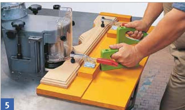
Möglichst Kniehebelspanner, Spannelemente mit Sterngriffen, Klemmhebel verwenden; Flügelschrauben, Schraubenmutter oder Ähnliches sind nicht geeignet, da zum Anziehen oder Lösen zusätzliches Werkzeug notwendig ist.
