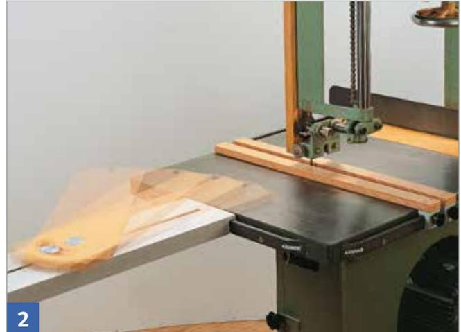
Kreissägevorrichtung so anbringen, dass der Zentrierpunkt bei eingeschwenktem Führungsbrett mit der Zahngrundlinie des Bandsägeblatts fluchtet.
