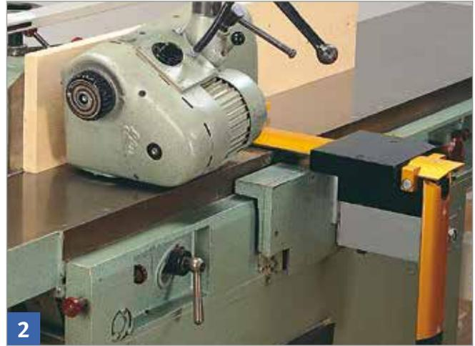
**Zum Fügen** von Werkstücken den Vorschubapparat zum Anschlag hinschwenken und leicht schräg zum Abnahmetisch einstellen.
