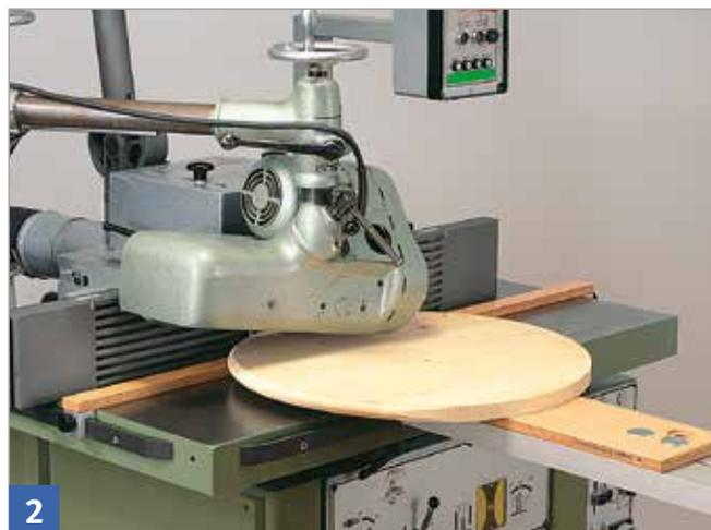
Den Vorschubapparat so einstellen, dass er das Werkstück nur mit einer Rolle vorschiebt und diese Vorschubrolle senkrecht zur Verbindungslinie zwischen Zentrierpunkt und Fräserdornachse steht; die Vorschubrolle muss das Werkstück über der Dickenausgleichsleiste transportieren.
