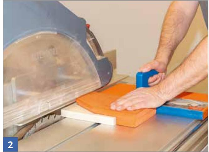
Bei kurzen Führungsflächen der Schablone eine Führungshilfe, z. B. Sägehilfe, benutzen.
