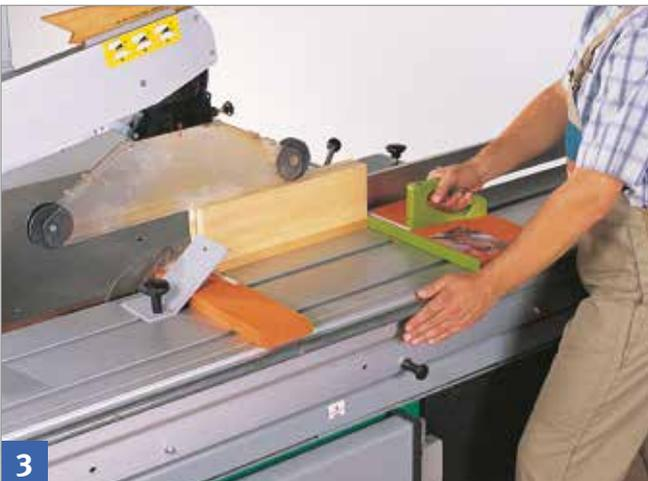
Vordere und hintere Sägehilfe einsetzen.
