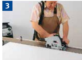
3 Einsetzsägen mit Tauchkreissäge und Führungsschiene mit Anschlagknocken (als Rückschlagsicherung)
