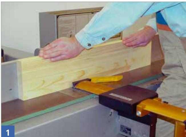
Schutzbrücke auf Werkstückdicke einstellen (entfällt bei Schutzbrücken mit Einlaufschub).
