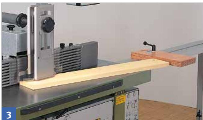
Das Fräswerkzeug vor dem Anschlag durch Bogenfeder, Druckschuh oder Schutz- und Druckvorrichtung (ohne Andruckeinstellung) verdecken.
