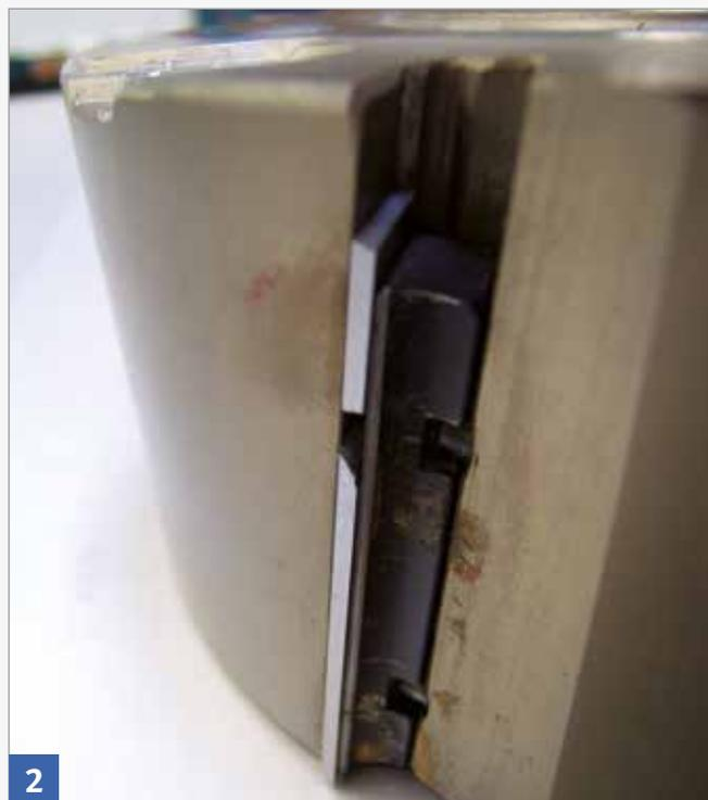
Durch Überlastung des Werkzeugs gebrochene Hartmetallschneide
