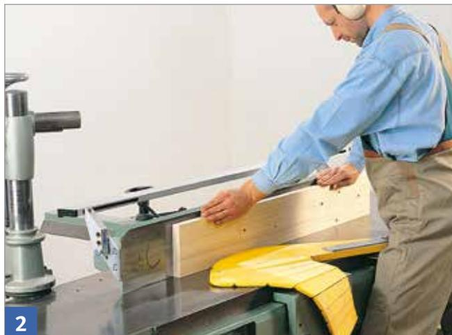
Das Werkstück mit der abgerichteten Fläche im Bereich des Aufgabetisches an den Anschlag anlegen.
