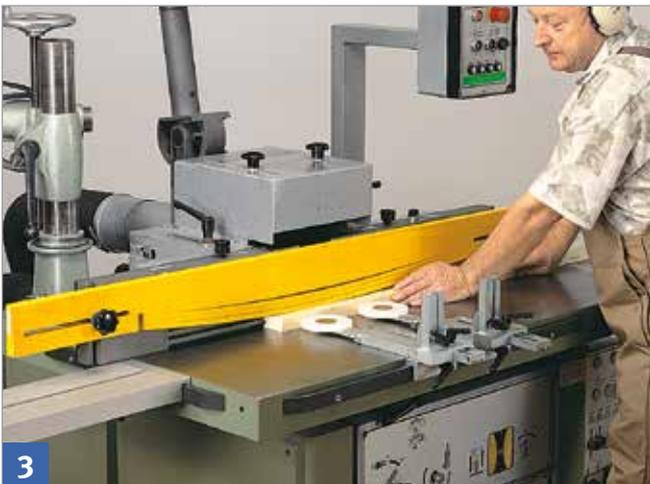
Bogenfeder so einstellen, dass ein Druck auf das Werkstück zum Maschinentisch hin erfolgt.
