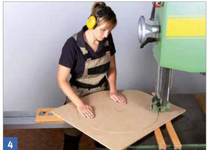
Nach dem Einschwenken das Werkstück gegen das Sägeblatt drehen und aussägen.
