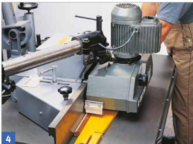
Möglichst mit Vorschubapparat arbeiten. Dabei Vorschubrollen parallel zum Anschlag ausrichten.
