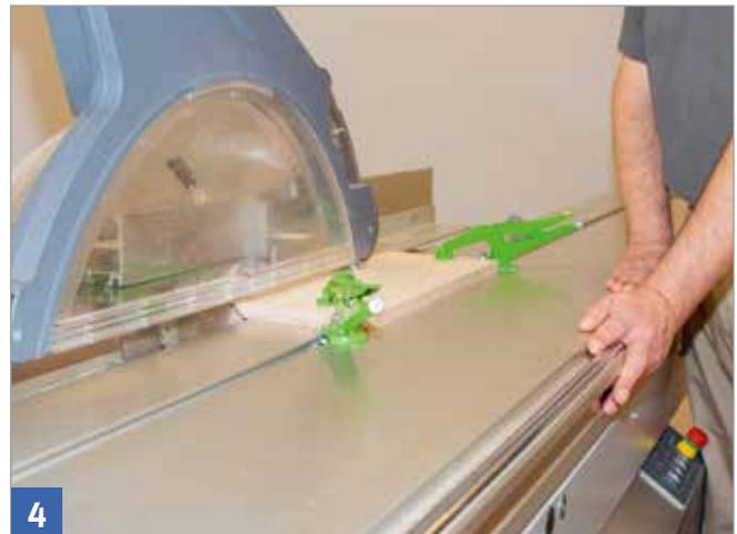
Schablonensägen mit Spannvorrichtung
