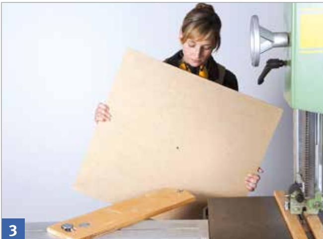
Bei ausgeschwenktem Führungsbrett das Werkstück auf den Zentrierpunkt auflegen und dem Bandsägeblatt zuführen.
