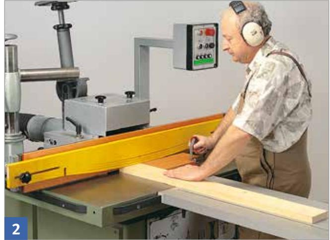
Linke Hand mit geschlossenen Fingern flach auf das Werkstück legen und gegen den Anschlag drücken.
