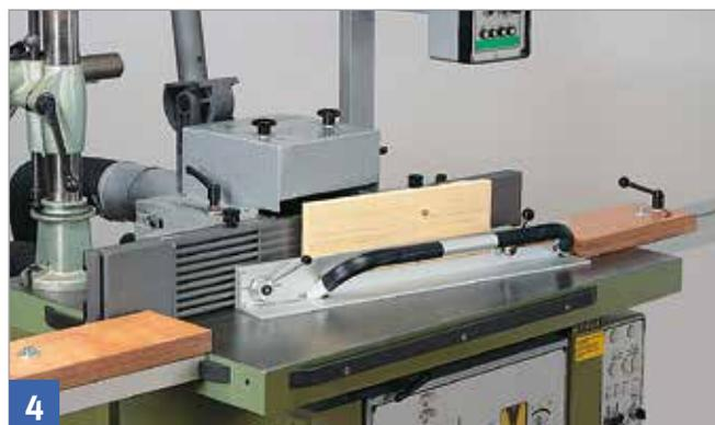
Bei kurzen Werkstücken Spannlade verwenden.
