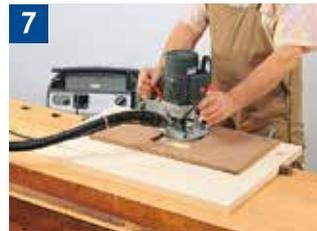
7 Einsatz der Handoberfräsmaschine mit Schablone
