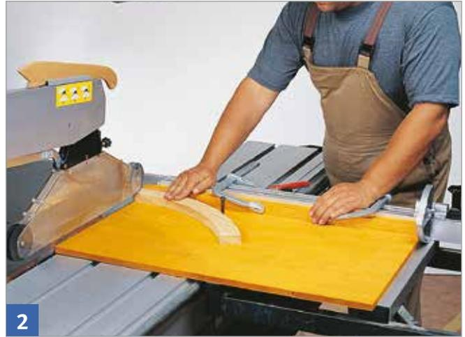
2 Werkstück am Queranschlag und am zweiten Anschlagpunkt anlegen und ersten Winkel sägen.
