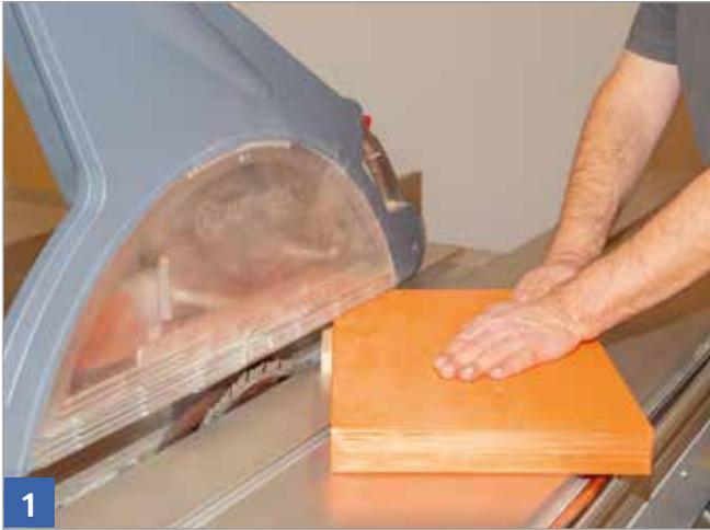
Winkel-Hilfsanschlag am Parallelanschlag befestigen, um ein Verkleben von Abfallstücken zwischen Anschlag und Kreissägeblatt zu vermeiden.
