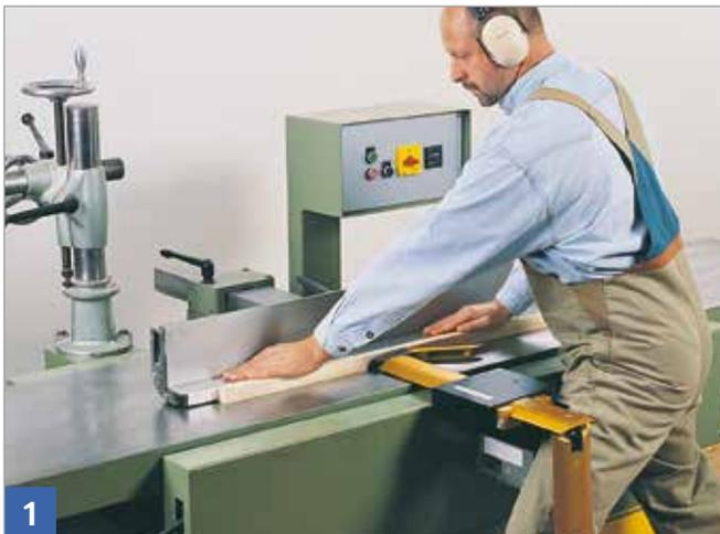
Schutzbrücke auf Werkstückdicke einstellen (entfällt bei Schutzbrücken mit Einlaufsnabel).
