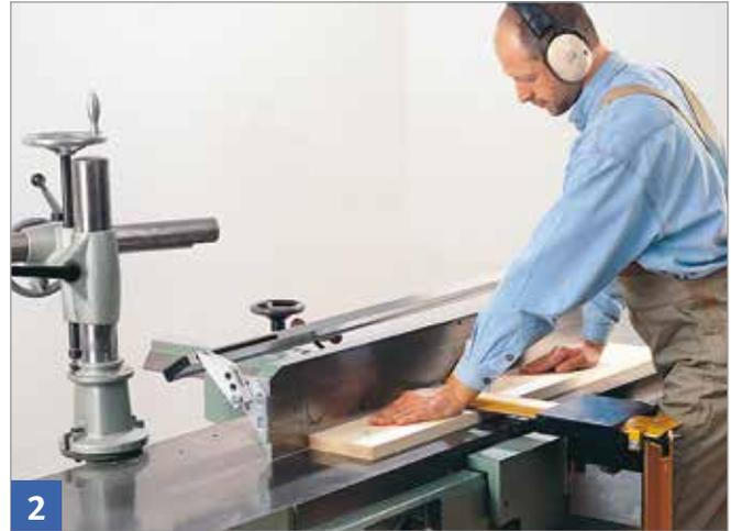
Schutzbrücke auf Werkstückdicke einstellen (entfällt bei Schutzbrücken mit Einlaufschnebel).
