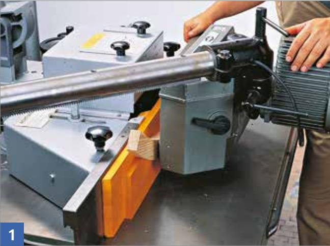
Führungsstück entsprechend dem Außenradius der Segmente herstellen, z. B. mit Segmentschneidvorrichtung; das sollte gleich beim Herstellen der Segmentbögen erfolgen.
