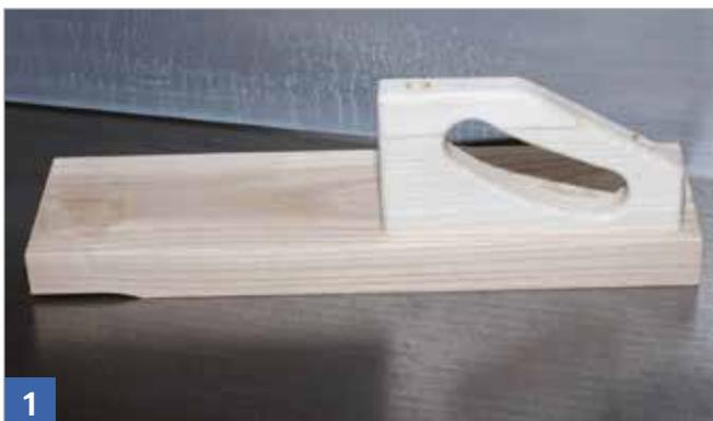
1 Beim Abrichten kurzer Werkstücke ein Schiebeh Holz (Bild 1)
