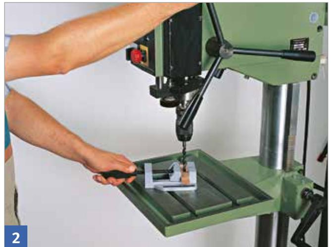
Kleine Werkstücke vor dem Bohren in Maschinenschraubstock spannen.
