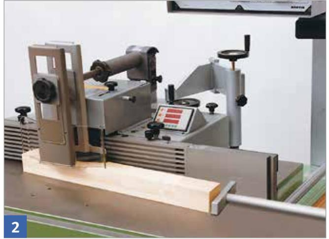
2 Rückschlagsicherung für Tischfräsmaschinen mit überlangem Tisch
