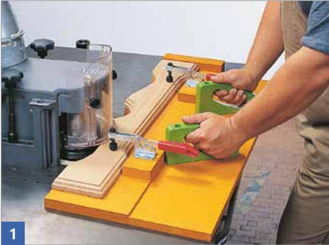
Anlaufring oder Bogenfräsanschlag zur Werkstückführung anbringen.
