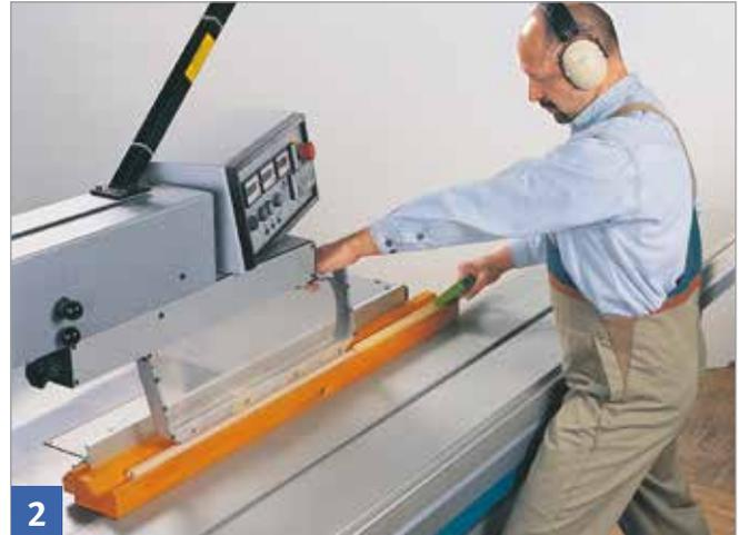
Vorrichtung (z. B. Winkelbrett) am Parallelanschlag befestigen.
