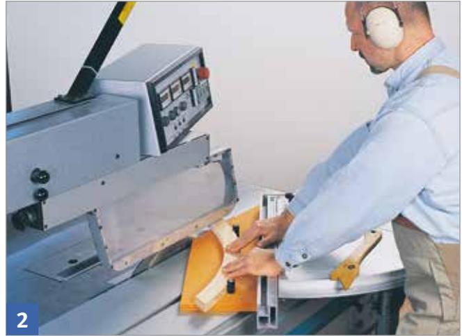
2 Gehrungsanschlag auf Winkel  $(90^\circ - \alpha)$  einstellen, Vorrichtung (Winkelbrett) am Gehrungsanschlag befestigen und Segment ansägen.
