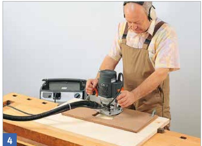
... oder Schablone aufsetzen und bei Maschinenstillstand Frästiefe einstellen.
