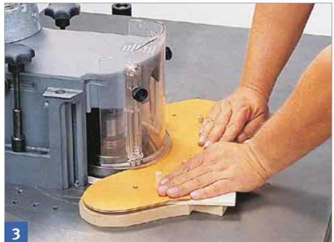
Zwischen Werkstück und Modellschablone muss deshalb eine Distanzplatte eingesetzt werden, die so dick ist, dass die Kante der dünnen Modellschablone über die gesamte Höhe am Anlaufring anliegt.
